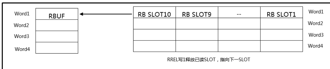
图 26-4 CAN RBUF 寄存器读接收缓冲器示意图
